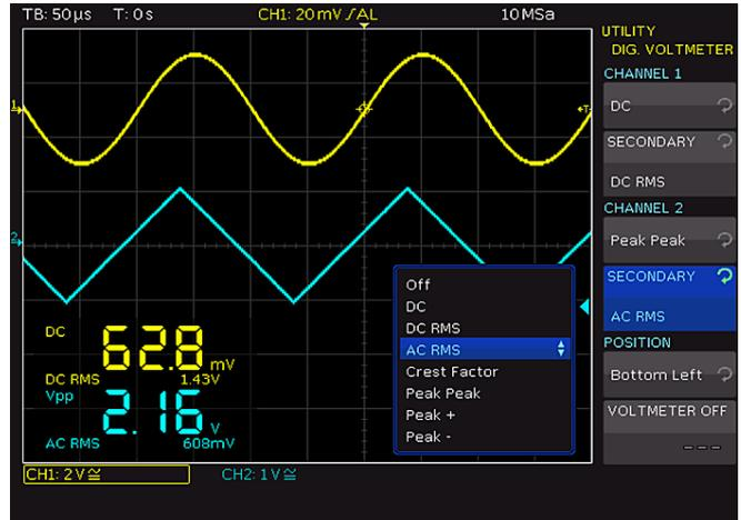
Fig. 9.12: Digital Voltmeter.
